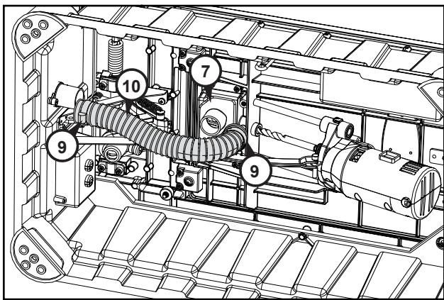
Pour installer le système de nettoyage des copeaux, couchez le Foreman sur le côté. À partir de l'intérieur de la base de l'outil (3), insérez le conduit d'aspiration (5) dans le trou situé à l'arrière de la base. Fixez-le de l'extérieur à l'aide de deux vis autotaraudeuses (6). Vissez le collecteur d'aspiration (7) à l'outil à l'aide de quatre vis à tête bombée (8).
